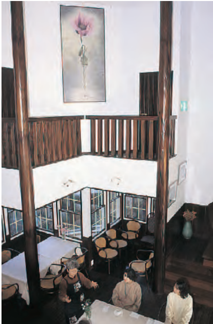
吹き抜けの部屋では、対流式であるエアコンの欠点が出ます。暖かい空気は上に溜まりますから顔は火照るのに足下がなかなか暖まらないといった状態が生まれます。
