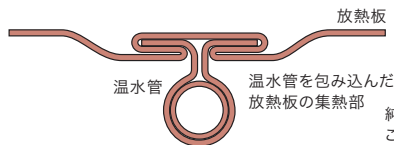
図4 一般的な温水式放熱板の構造
