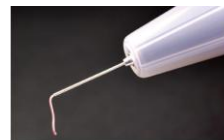
加熱軟化により流動化した ペレット
