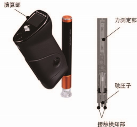
Fig. 1 SOFTGRAM の概略図
