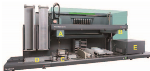
A 分注シリンジの付いたアーム, B 位置調整マニピュレーター, C カラムホルダー, D プレートシャトル, E プレートリーダー
