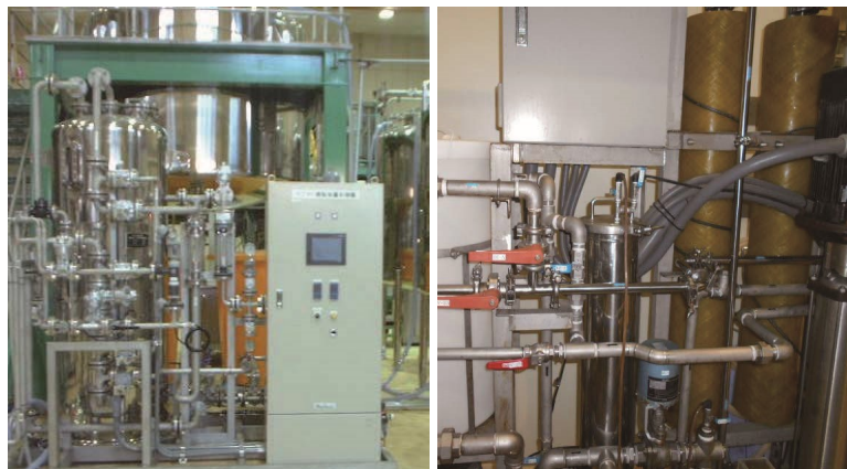
図4 工場生産用イオン交換クロマトグラフとNF膜ろ過装置 左：イオン交換塔，右：NF膜モジュール
