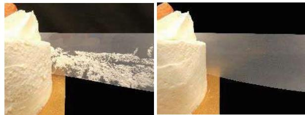
Fig. 5 撥油フィルムによりケーキの付着が抑制された様子(右)
