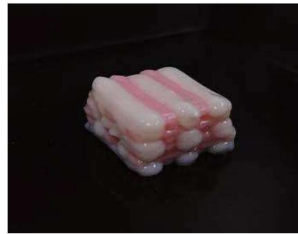
(d) FP-2500の二色刷りを活かして井桁構造を組み込んだ介護食モデル
