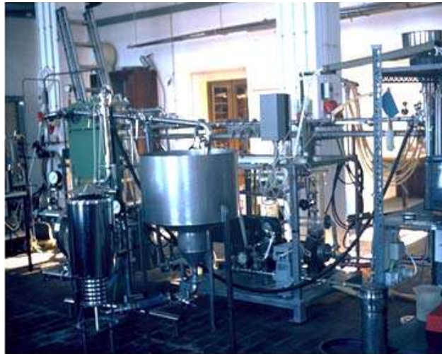
図2 使用した UF 膜濾過システム
