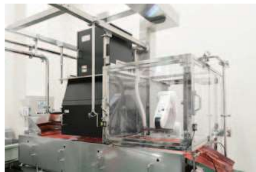
図2 ジャム・フルーツブレッド用異物検査装置 左の黒い装置が異物検査装置。検出された異物・夾雑物は、右の透明なBOX内のロボットアームに装着されたバキューム装置で吸い出して除去する。
