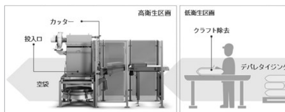
図7 25kg バッグ用半自動解袋設備の構成例
