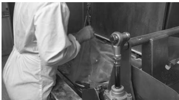
図9 25kg バッグ用半自動解袋設備 袋回収例
