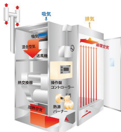
図2 湿球温度制御棚段乾燥機 木原製作所椎茸乾燥用 DDS 装置
