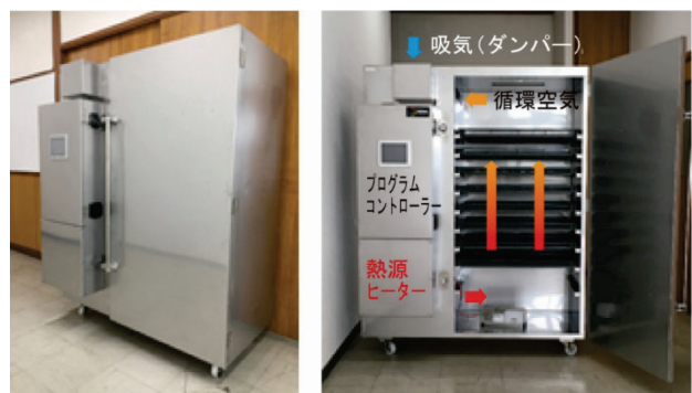
規格：(W)1,200×(D)793×(H)1,550 mm 電源：3相200V 処理量：約16kg/回 トレイ：651×519mm 7枚
